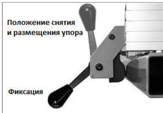
Рис. 7: положения рычага упора
