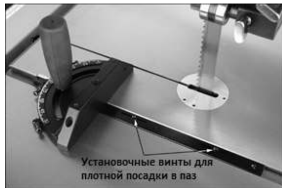
Рис. 34: настройка приспособления для распила под углом
