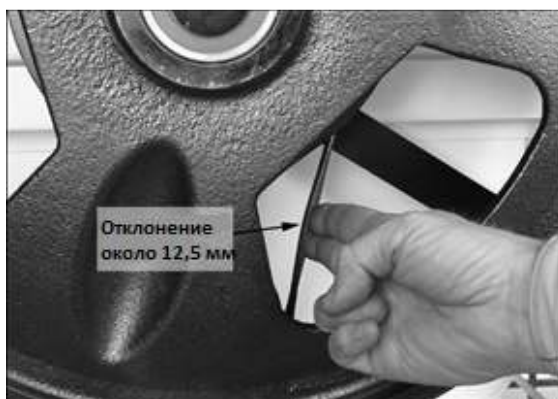
Рис. 38: отклонение ремня
