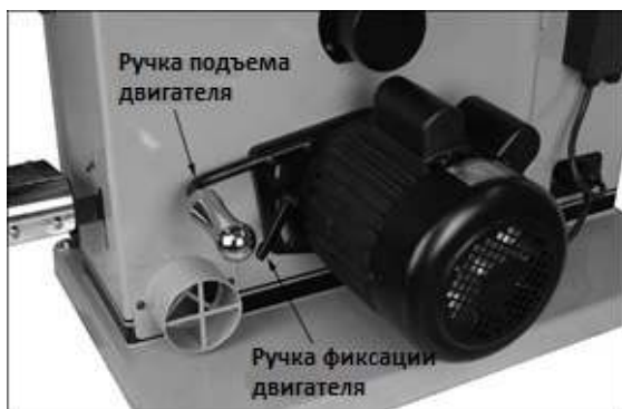
Рис. 36: ослабление натяжения ремня
