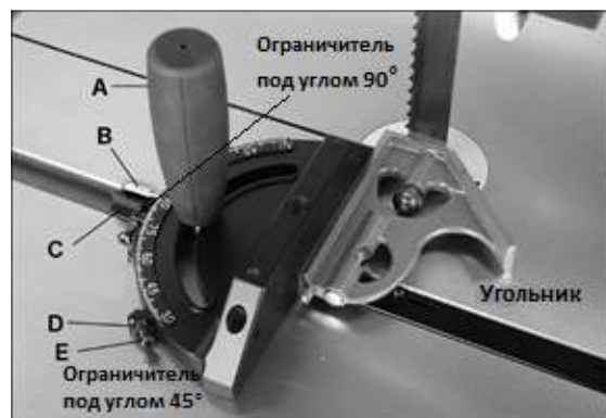
Рис. 35: настройка приспособления для распила под углом
