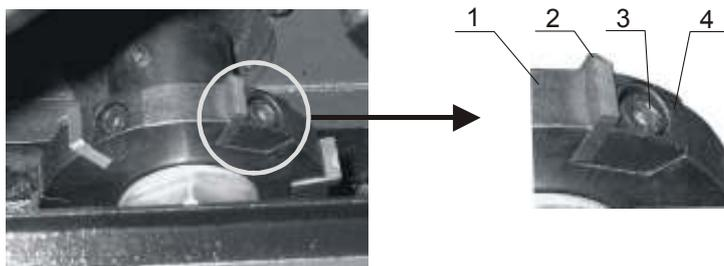
Для того чтобы сменить режущую пластину выкрутите зажимной болт (3). снимите пластину (2). Тщательно очистите соприкасающиеся поверхности. Установите пластину, действуя в обратном порядке. При затяжке зажимного болта следите за правильной посадкой пластины.
