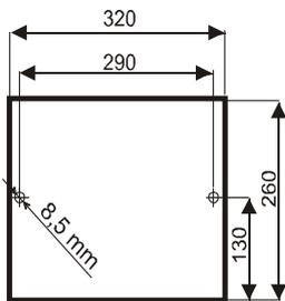
Внимание: В целях обеспечения безопасности и надежной работы станка правильно установите и прочно закрепите станок на основании (основанием может служить жесткая поверхность, которая отвечает основным характеристикам станка и его рабочей нагрузке). Несоблюдение этих условий может привести к непредвиденному смещению станка или частей его конструкции, и в дальнейшем к остановке оборудования (см. рис.).
