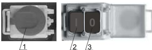
Выключатель находится в верхней части станка. Станок запускается нажатием зеленой кнопки (2), выключается при помощи красной кнопки (3).
