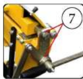
Смазывание тяги поднимания нажимной балки тила: стандарт (масленка)
