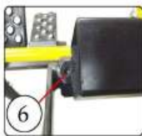
Смазывание подвижных точек носового механизма поднимания нажимной балки (масленка)
