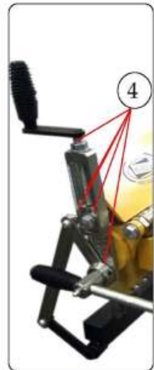
Смазывание подвижных точек механизма поднимания нажимной балки - тила загибание листа с четырех сторон (масленка)
