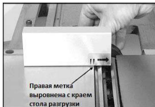
Рис. 22 (строгальный вал с прямым расположением ножей)
