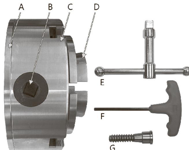
A – хвостовик, B – отверстие для ключа, C – корпус, D – кулачки, E – ключ зажимной, F – ключ шестигранный, G – вставка винтовая
