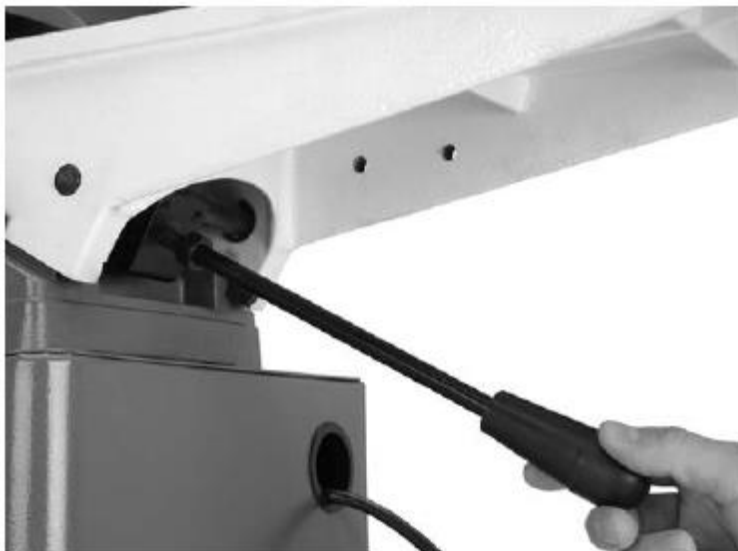
Рис. 16. Установка рычага подводного стола
