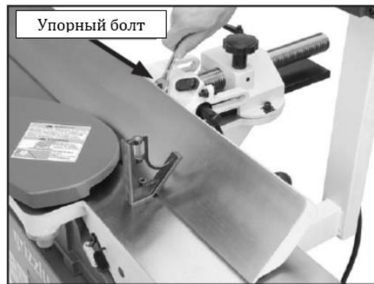
Рис. 29. Контргайка упора под углом 45° положения параллельного упора
