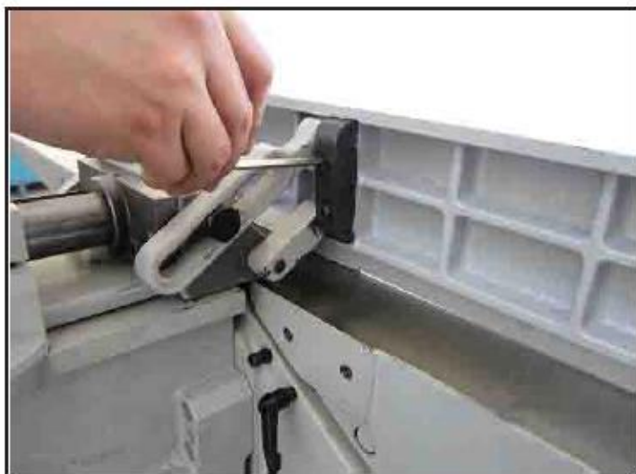
Рис. 11. Установка узла параллельного упора
