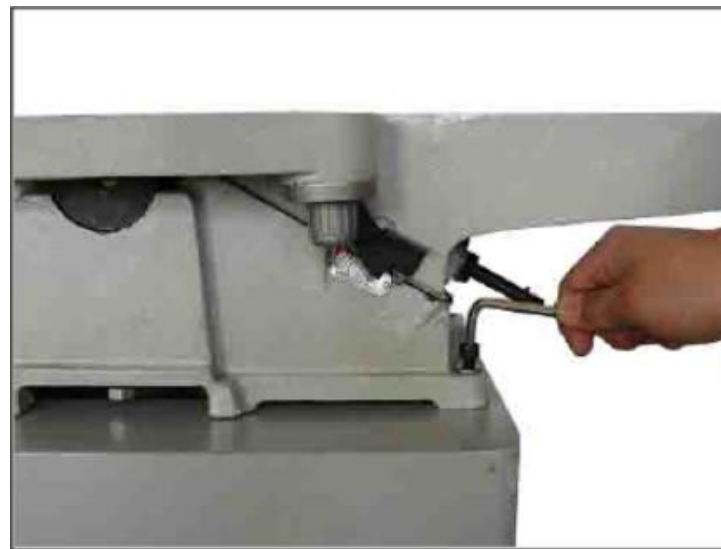
Рис. 4. Установка переднего крепёжного болта
