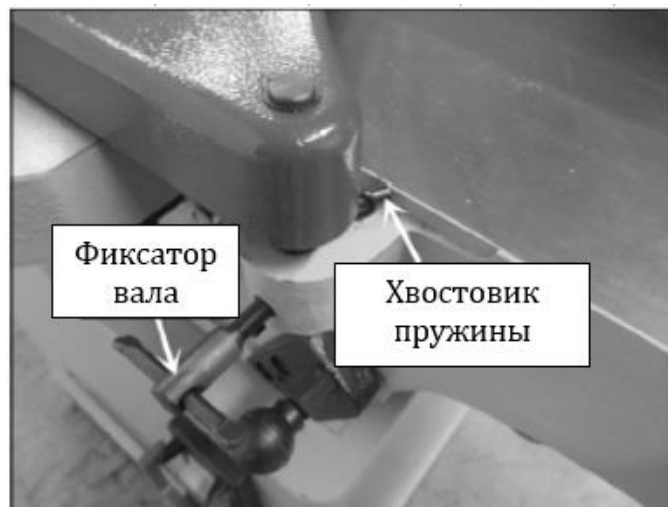
Рис. 13. Установка патрубка аспирации опилок
