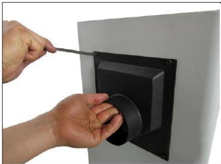
Рис. 14. Установка патрубка аспирации опилок
