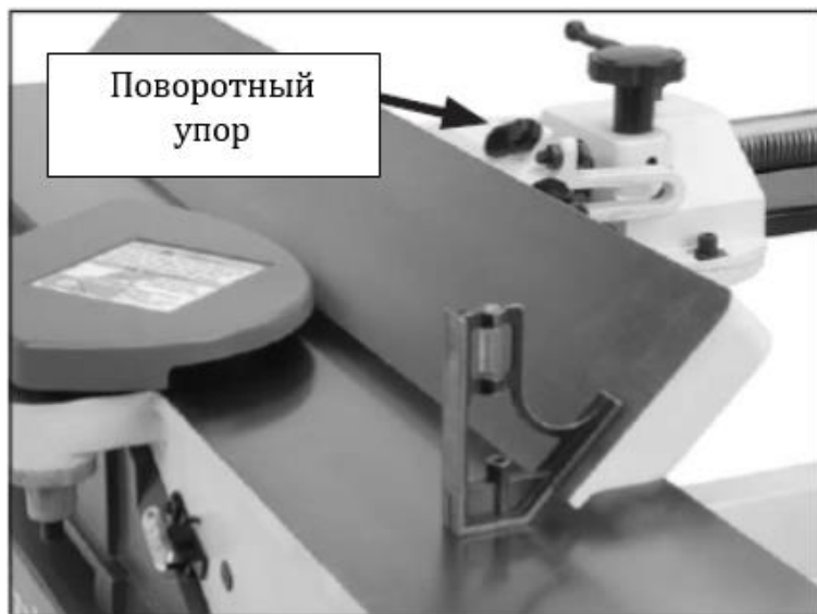
Рис. 28. Регулировка параллельного упора под углом 45° наружу
