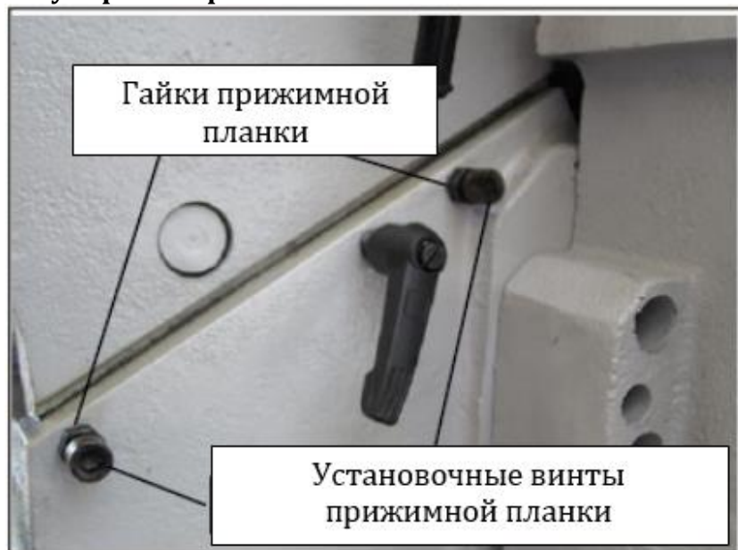
Рис. 30. Органы регулировки прижимных планок выводного стола
