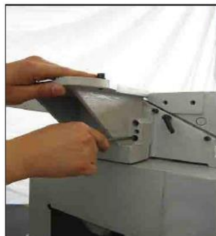
Рис. 9. Собранный кронштейн крепления каретки
