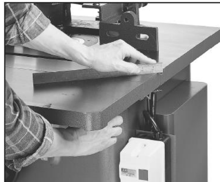
Рис. 10. Регулировка совмещения поверхностей
