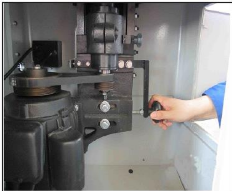
Рис. 14. Регулировка натяжения клинового ремня
