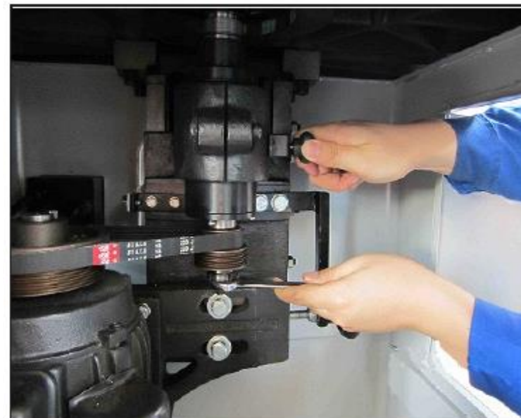
Рис. 7. Затяжка и ослабление шпинделя
