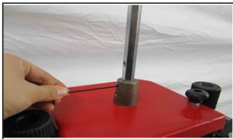
Рис. 11. Установке вертикальной штанги IV
