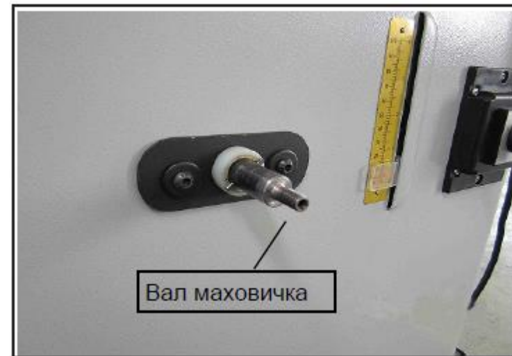
Рис. 3. Расположение вала маховичка
