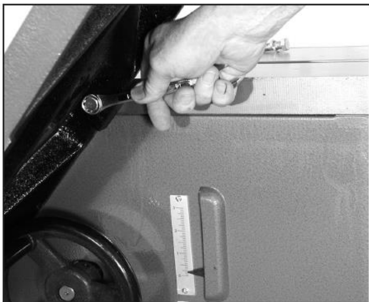
Рис. 9. Установка удлинительной консоли
