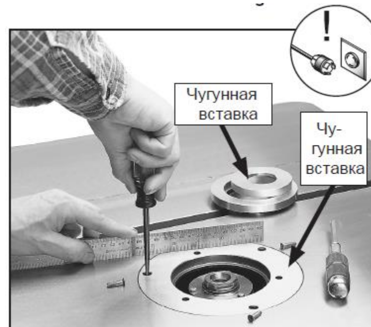
Рис. 8. Выравнивание вставки стола
