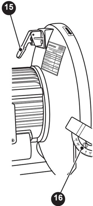
15. Рычаг тормозного устройства
