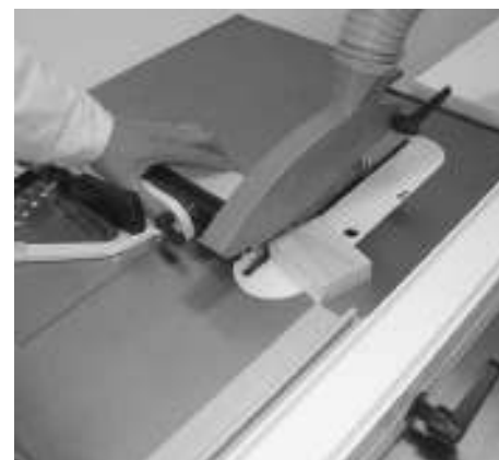
А.3. Поперечный распил при помощи упора
