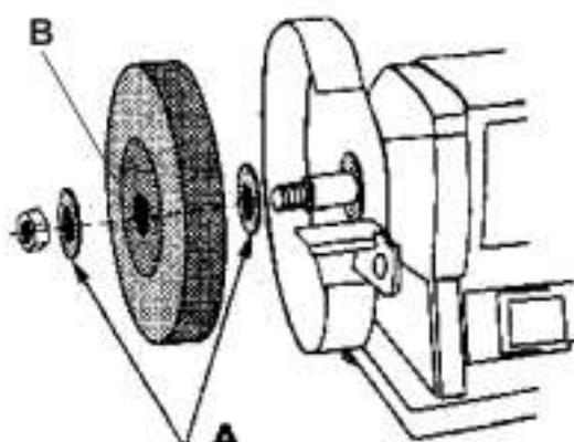
При установке нового круга установить между кругом и фланцем «А» бумажную прокладку «В». Установите круг с фланцами и затяните гайку. Новый круг выровняйте до малого биения (проведите правку приспособлением для правки кругов).
