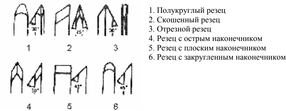
Рис. 16 – Шесть наиболее распространенных типов резцов
