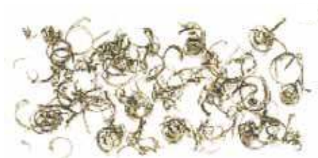
Очень мелкая, пылевидная стружка - подача должна быть увеличена
