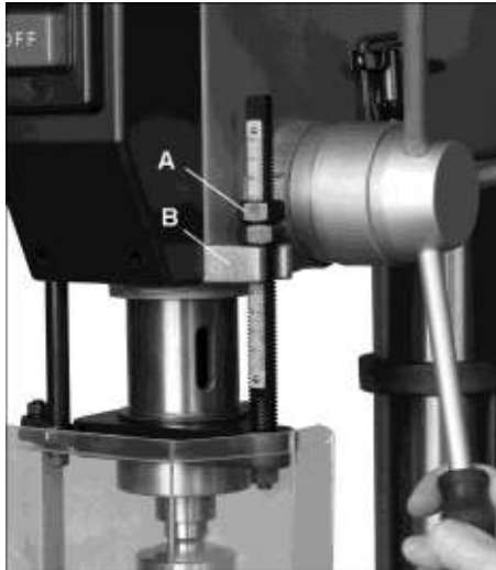
Рис. 8-1: регулировка упора глубины сверления
