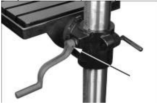
Рис. 6-1: установка изогнутой рукоятки
