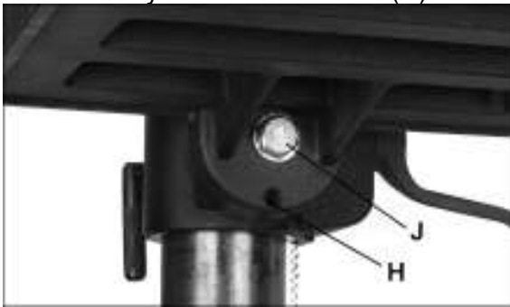
Рис. 8-4: наклон стола (только для IDP-17)
