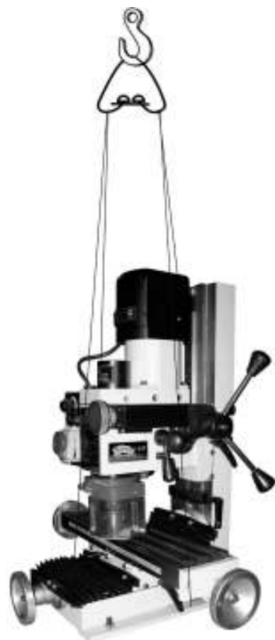
СХЕМА СТРОПОВКИ СТАНКА "КОРВЕТ 417"
