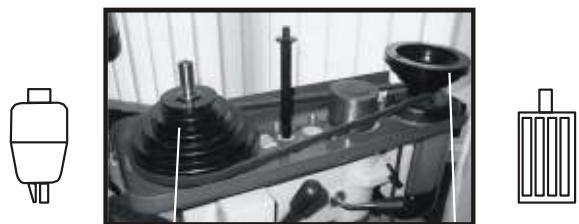
Для того, чтобы изменить скорость вращения, прежде всего, остановите двигатель, откройте крышку, ослабьте зажимные болты двигателя, а рычаг натяжения потяните по направлению к
