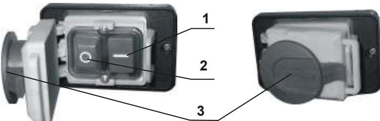
В соответствии с нормами EN 60204-1 п. 7.3 рекомендуется цепь розетки для подсоединения подвижного привода станка оснастить защитным элементом для того, чтобы исключить перегрузку электродвигателя. Защитный элемент должен соответствовать характеристикам двигателя и должен быть установлен на номинальный ток электродвигателя, приведенный на его производственном щитке.
