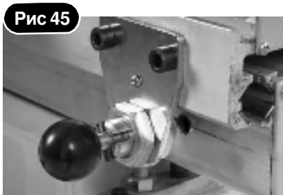
Ручка фиксации положения подвижного стола, установлена в крайнем положении
