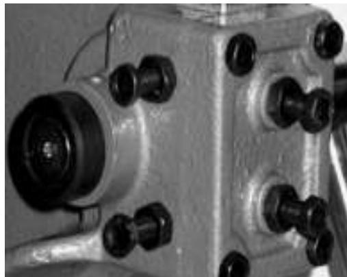
Регулировочные винты с контргайками служат для регулировки зазора между рабочим стержнем и направляющими в корпусе пресса.
