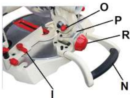
Сур. 2 М - Сөндіргіш N - Артқы тұтқа O - Кескіш бастың бекіткіші P - Көлбеу шкаласы Q - Дайындама қысқышы R - Көлбеу бекіткішінің тұтқасы
