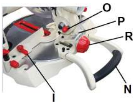
Рис. 2 N - Задняя ручка O - Фиксатор режущей головы P - Шкала наклона R - Ручка фиксации наклона I - Фиксатор поворота
