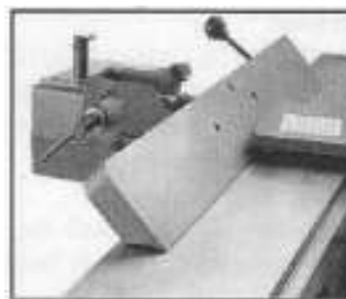
Рисунок 12. Линейка фуговального станка в положении упора под углом 45°.
