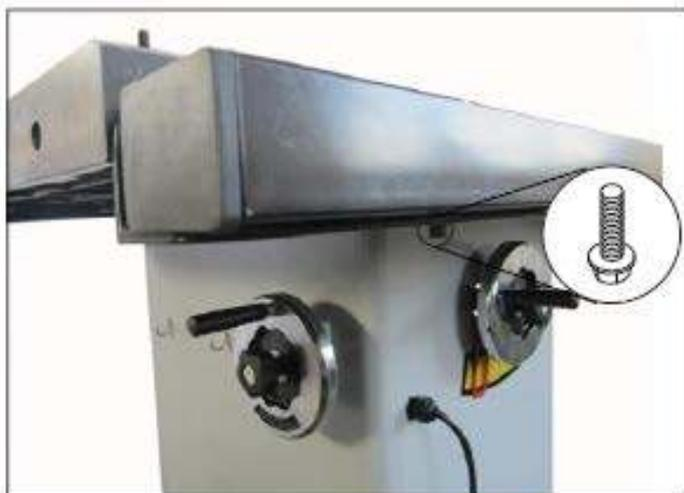
Рис. 11. Установленная на передней направляющей труба параллельного упора
