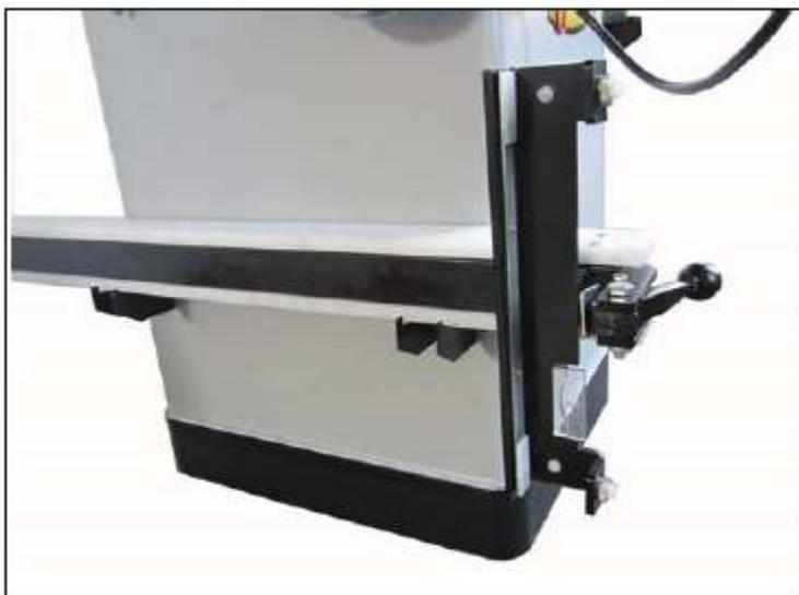
Рис. 15. Крепление двух кронштейнов подручника
