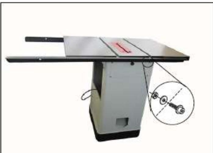
Рис. 10. Установленная на станке задняя направляющая
