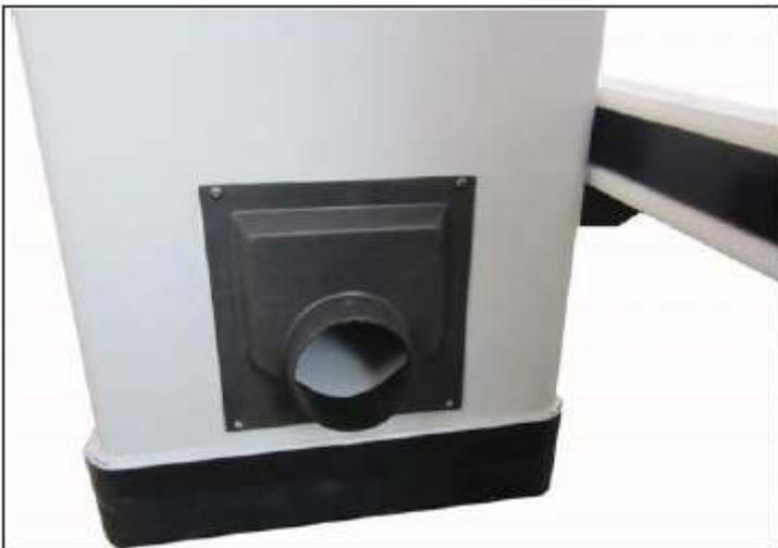
Рис. 17. Крепление штуцера аспирации опилок
