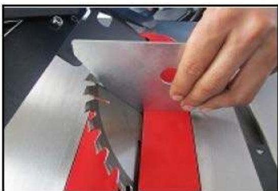
Рис. 29. Наклон дисковой пилы на угол 45°
