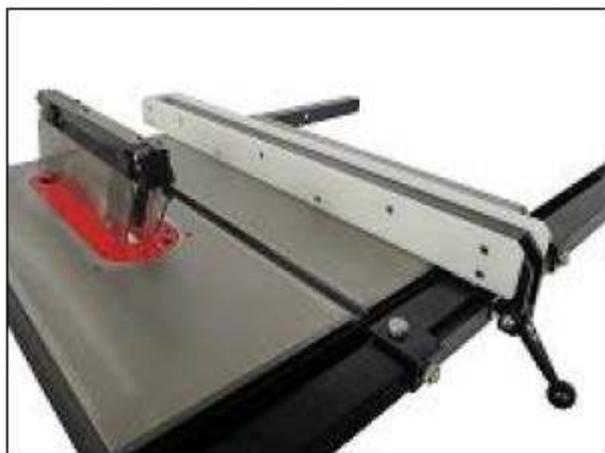
Рис. 21. Узел параллельного упора
