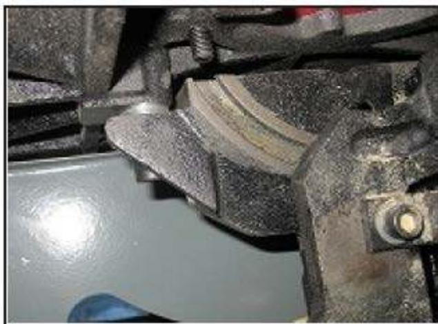
Рис. 24. Направляющие качающихся опор и червяк наклона
