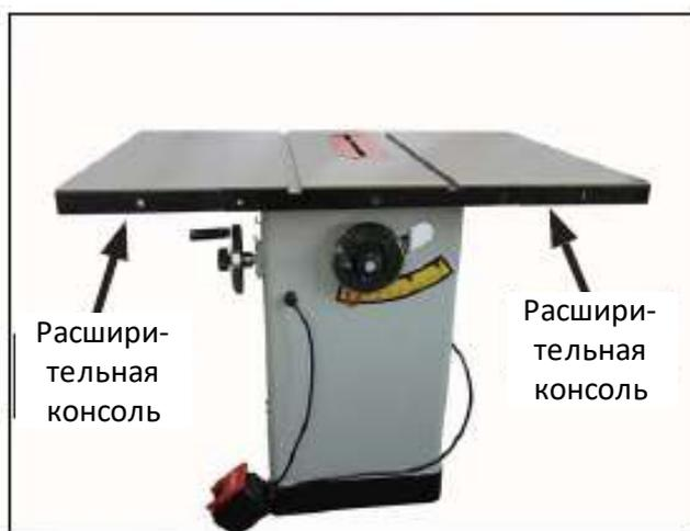
Рис. 6. Установленные на станке расширительные консоли
