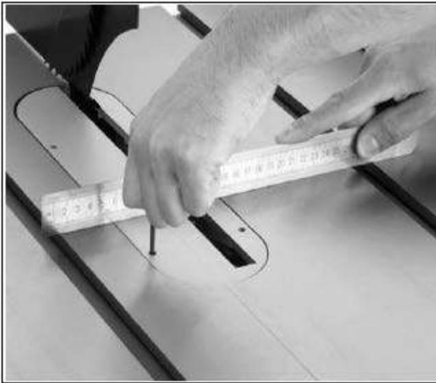
Рис. 23. Регулировка вставки стола по высоте
