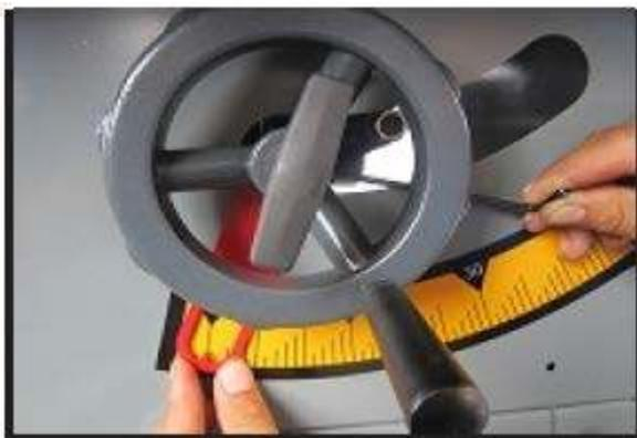
Рис. 28. Установка указателя на 0°
