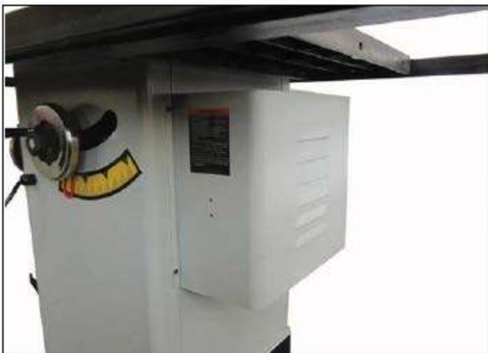
Рис. 13. Крепление крышки двигателя
