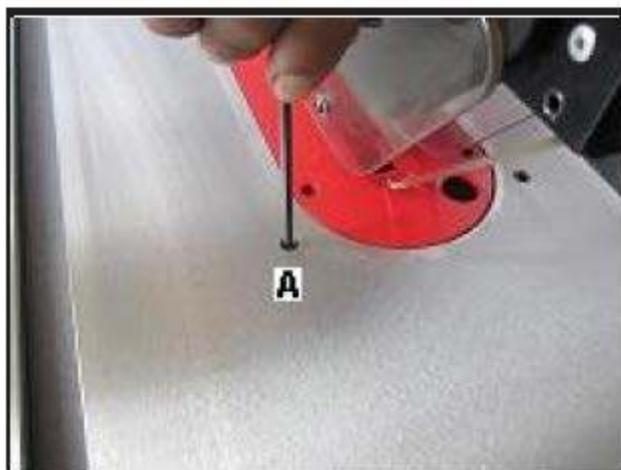
Рис. 27. Регулировка под 90° с помощью установочного винта
