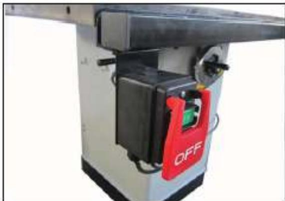
Рис. 12. Закреплённый на направляющей выключатель
