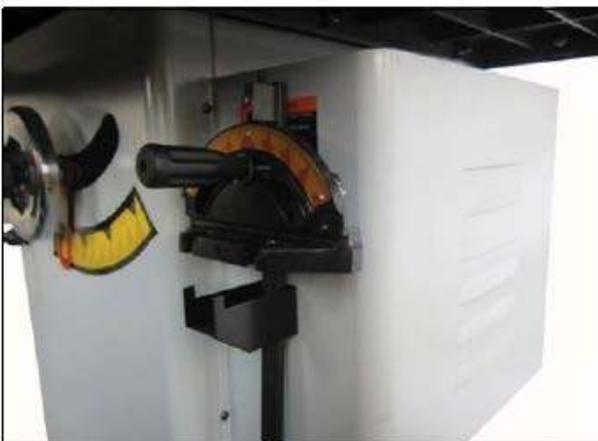
Рис. 14. Крепление кронштейна подручника
