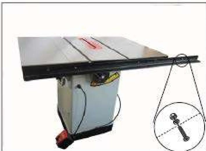
Рис. 9. Установленная на станке передняя направляющая
