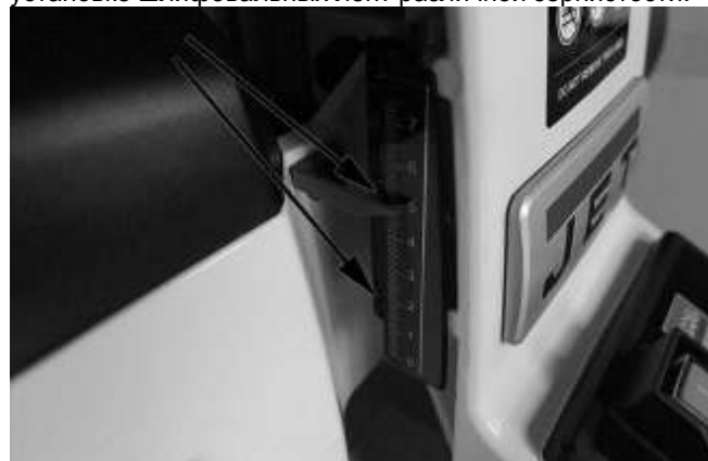
Рис. 8-1: настройка шкалы глубины
