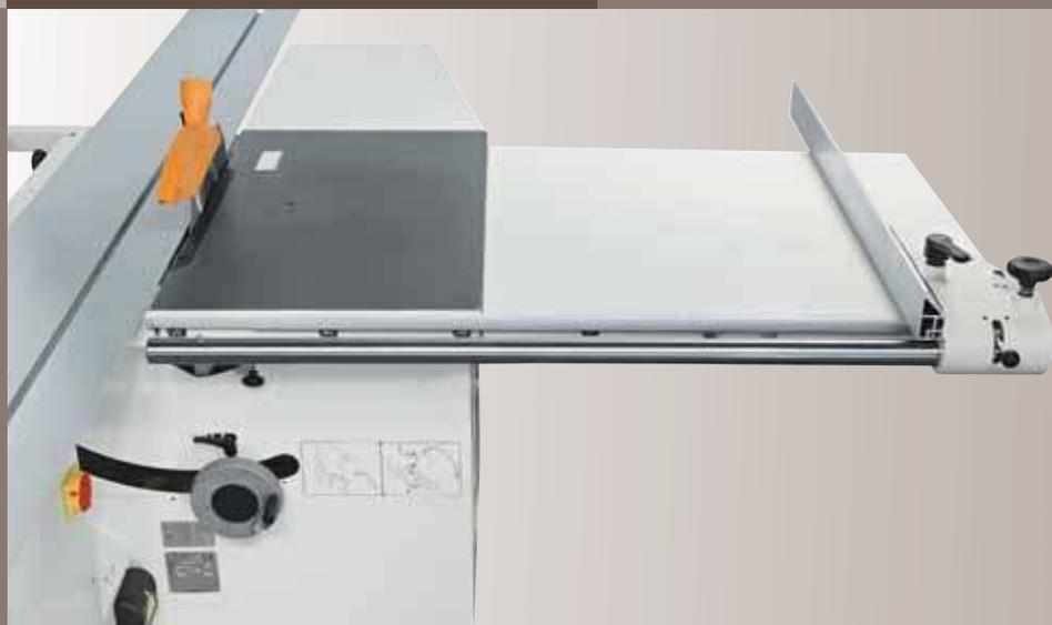
Большое удлинение чугунного стола обеспечивает надёжную поддержку деталей после распила
