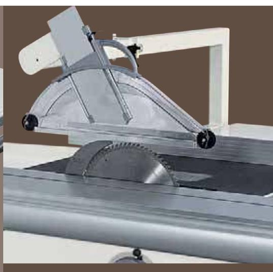
Система линейного перемещения каретки оснащена призматическими направляющими, обеспечивает точность и прямолинейность пиления. Надежность системы достигается за счет уникальной технологии крепления направляющих. Направляющие не наклеиваются, а фиксируются по всей длине путем завальцовывания в нижнюю алюминиевую часть каретки.
