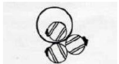
8. РЕВЕРСИВНОЕ ФОРМИРОВАНИЕ ТРУБЫ - с помощью машины можно сформировать диаметр, равный диаметру валов, или немного больший. Для выполнения регулировки по толщине материала и определения длины заготовки см. инструкции, приведенные в пунктах 2-4.
