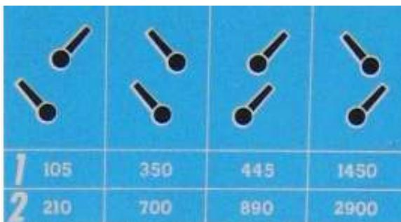
Скорость вращения шпинделя задается переключением «рукожоток выбора скорости шпинделя» (5) и выбором скорости вращения двухскоростного электродвигателя (7).
