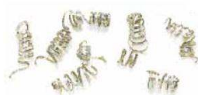
Свободно намотанная (витая) стружка идеальные условия резания
