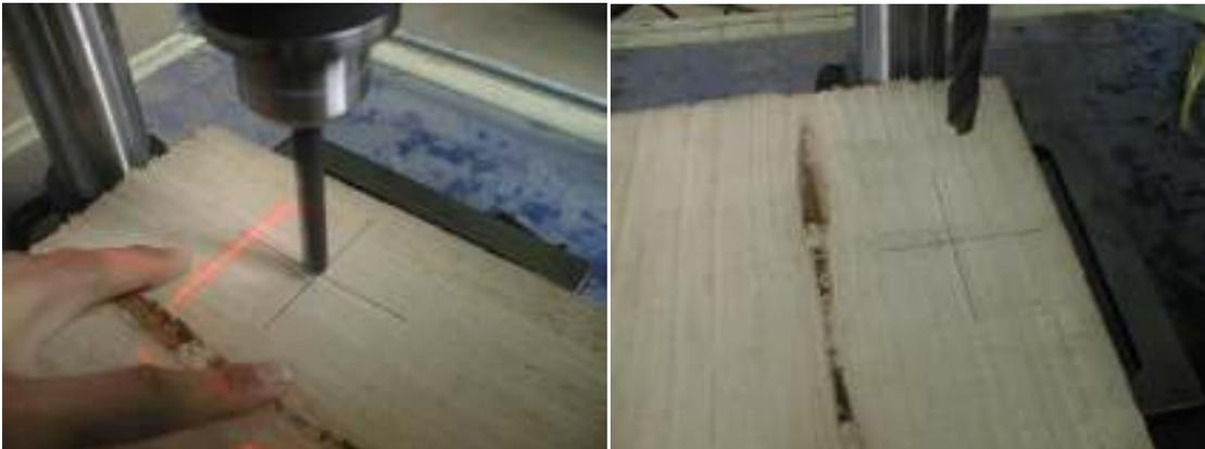
Отрегулируйте лазерный указатель так, что бы перекрестие лазерного указателя и разметка на шаблоне совпали.
