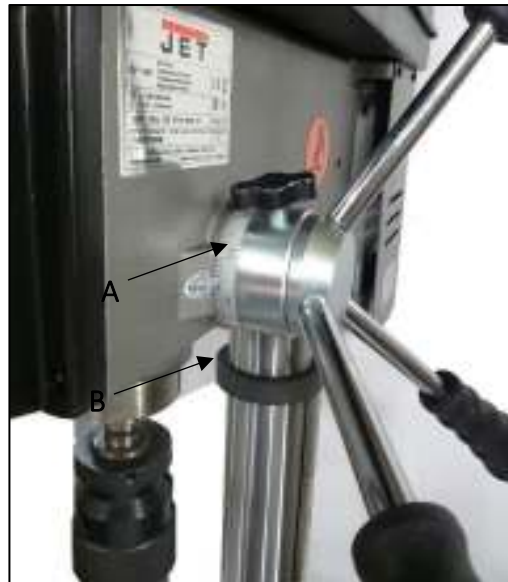
Рисунок 8-1. Регулировка ограничителя глубины сверления
