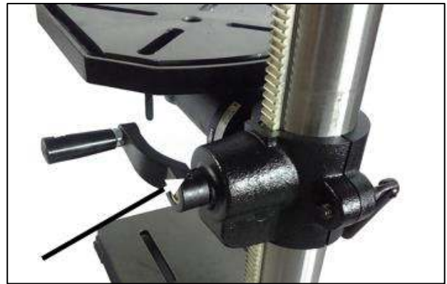
Рисунок 6-1: Установка коленчатой рукоятки
