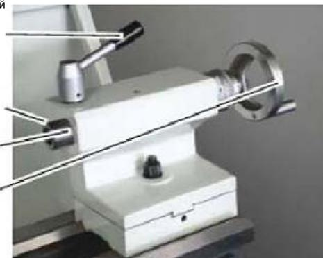
Регулировочный болт : В случае регулировки задней бабки, позволяет удерживать ее в среднем положении.
