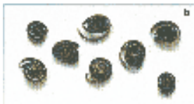
Толстая, тяжелая, с голубым отливом стружка - полотно перегружено
