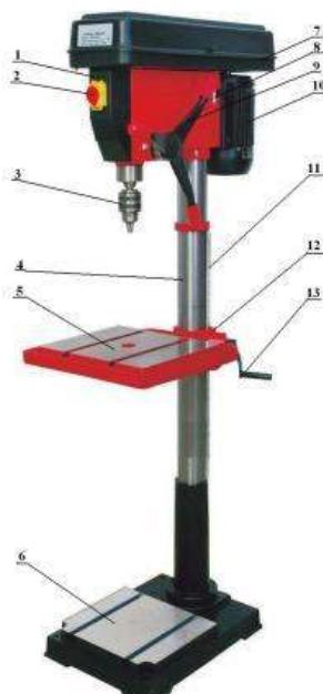
Включите вращение шпинделя зелёной кнопкой «I» и ручкой перемещения шпинделя (9) подведите режущий инструмент к обрабатываемой детали, начните обработку. По окончанию работы уберите стружку, протрите и смажьте станок.
