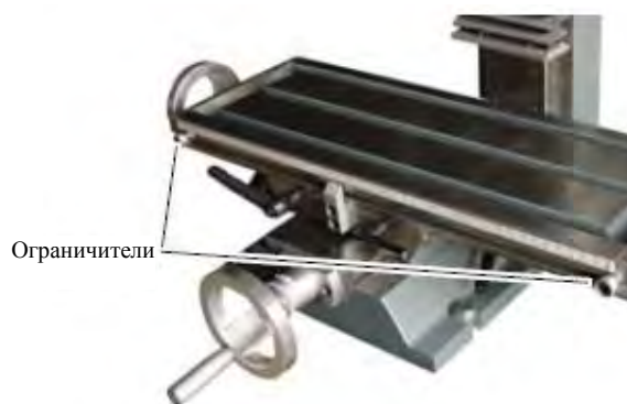
Рис. 4-11: Ограничители хода по оси X
