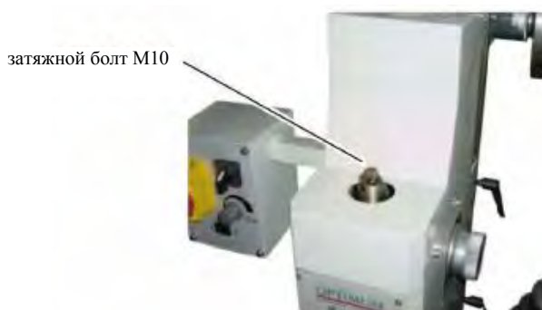
Рис. 4-5: Сверлильно-фрезерная головка с крышкой двигателя
