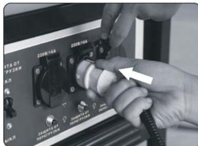
**Откройте брызгозащитную крышку розетки и вставьте вилку электропотребителя.**
